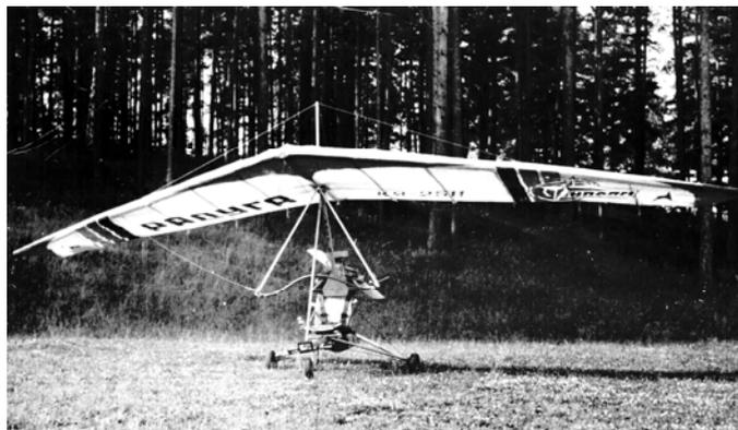
Рис. 4. Серийный мотодельтаплан «Радуга»
